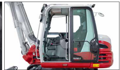
Amplia cabina insonorizada, pobre en vibraciones, compartimentos de almacenaje, entrada ancha, fijación masiva de puerta, cristal frontal abatible, aire acondicionado
