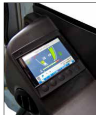
Nuevo display, más resistente a arañazos de cristal laminado antivaho con visualización automática de la cámara de marcha atrás. Menú de taller con nuevas funciones.
