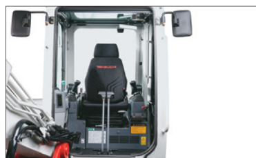
Confortable cabina insonorizada con escasa vibración y asiento de lujo (Canopy: versión resistente a la intemperie) para mejorar las condiciones de trabajo
