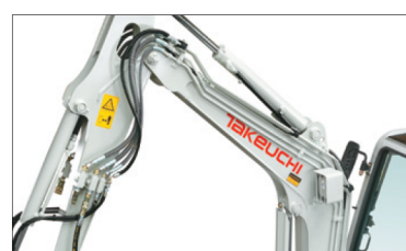
3 instalaciones hidráulicas de serie para una gran variedad de accesorios (1ª y 2ª instalación hidráulica controladas por potenciómetros), opcional: 4ª instalación hidráulica
