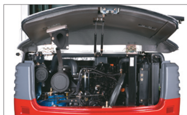
Motores con niveles reducidos de ruidos y emisiones de gas, compartimiento espacioso del motor, tubo de escape hacia arriba, contrapesos macizos
