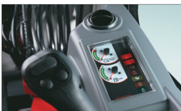
Panel de control con aviso acústico y visual en caso de fallo de funcionamiento
