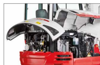
Amplias tapas abatibles para facilitar el mantenimiento y un acceso cómodo a los componentes hidráulicos y al motor.
