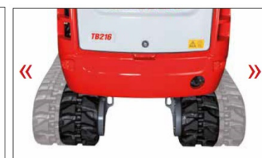
Tren de rodaje con ensanchamiento hidráulico de anchura de vía.
