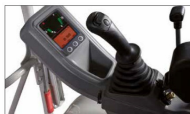
Panel de control con aviso acústico y visual; dirección proporcional del 2º circuito hidráulico desde el joystick derecho.
